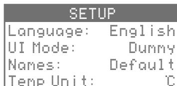
MC3000 имеет множество параметров, которые пользователь может проверить или контролировать. Более общие настройки доступны в глобальном представлении настройки (GSV). Они влияют на работу всего устройства, а не только на один слот или программу. Изменения, внесенные в параметры, не сохраняются до тех пор, пока будет нажата кнопка **ENTER** (= Сохранить) секунды на две.
